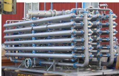
Grâce à des techniques de nettoyage performant, les membranes en Polyethersulfone peuvent filtrer en mode frontal des eaux chargées et ainsi réduire la consommation d'énergie et les coûts d'exploitation.
