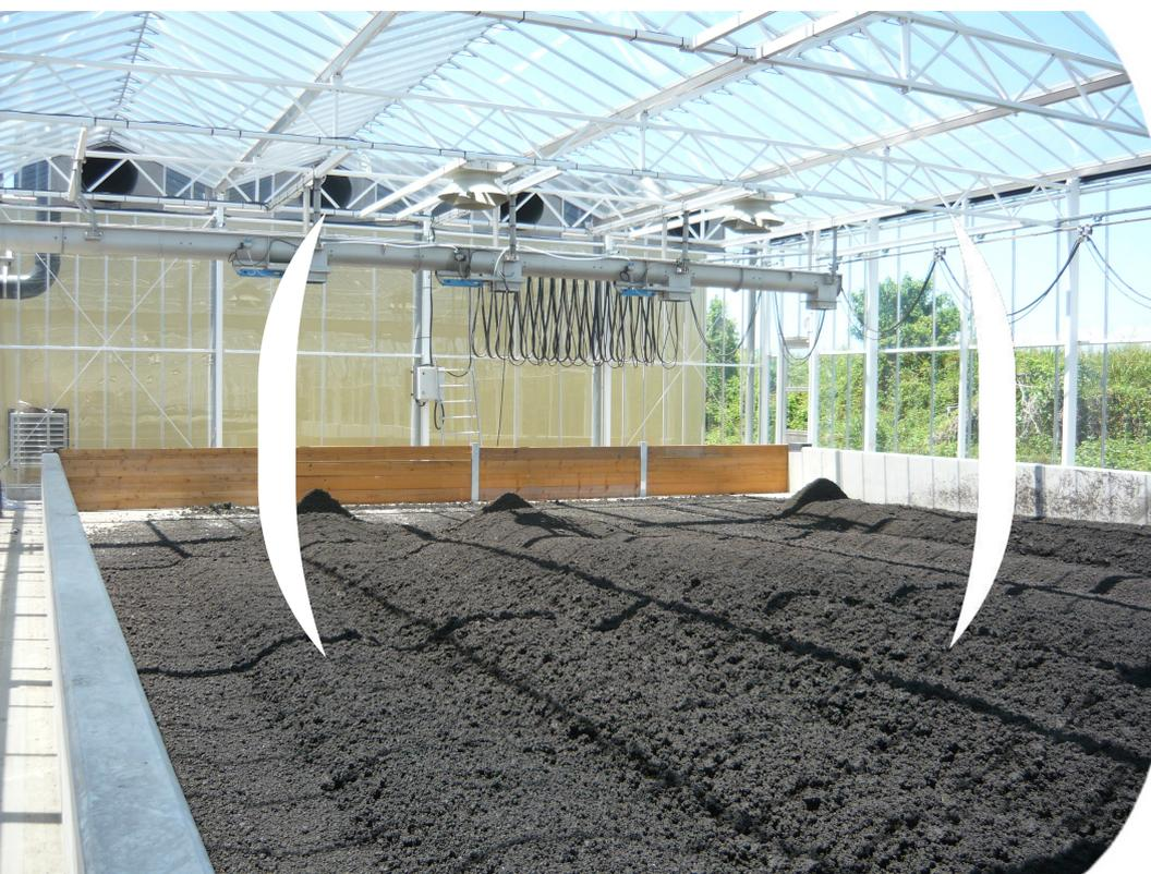
Le séchage solaire **HELISOL™** repose sur la mise en contact, sous une serre, d'un air régulièrement renouvelé et d'une boue répartie sur une dalle, brassée et aérée mécaniquement.
