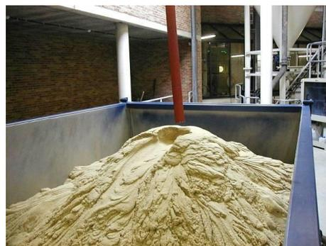
Egouttage des billes de carbonate de calcium en benne drainante.
