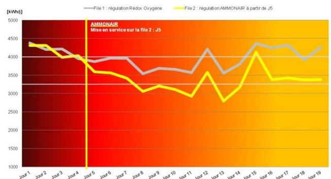
Le fonctionnement à débit d'air réduit au juste besoin diminue la densité d'aération améliorant le rendement de transfert en oxygène.
